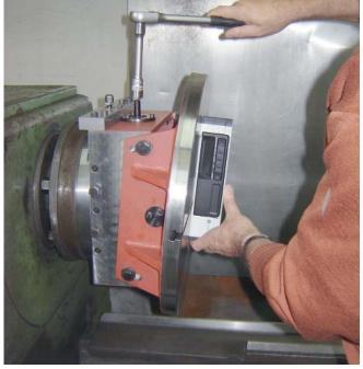
Einstellung des Neigungswinkels mit digitalem Winkelmessgerät
