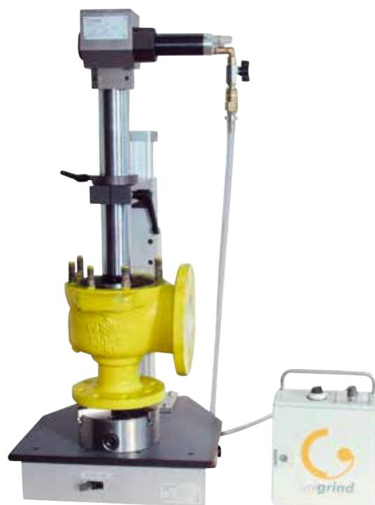
SVS 1 mit Maschinenständer beim Schleifen eines Ventils
