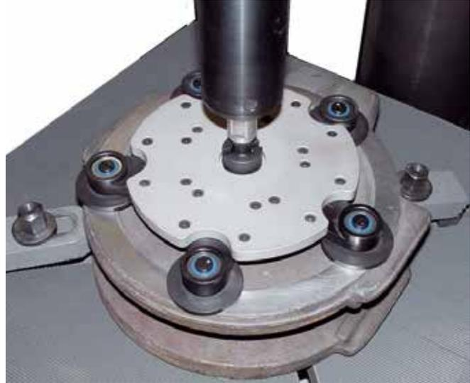
Schleifen eines Schieberkeils mit einer Planetenscheibe
