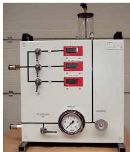
TSL 40 transportables Leckageprüfsystem
