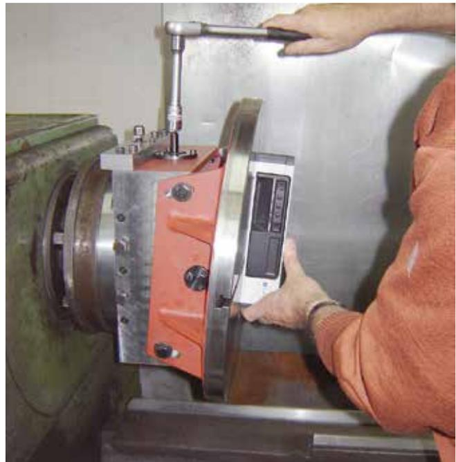
Einstellung des Neigungswinkels mit digitalem Winkelmessgerät
