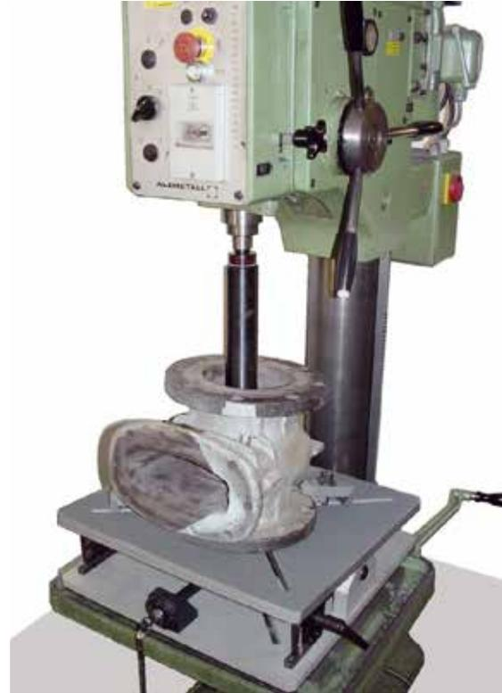
UNT 2 + Adapter, Schleifen eines Schiebergehäuses
