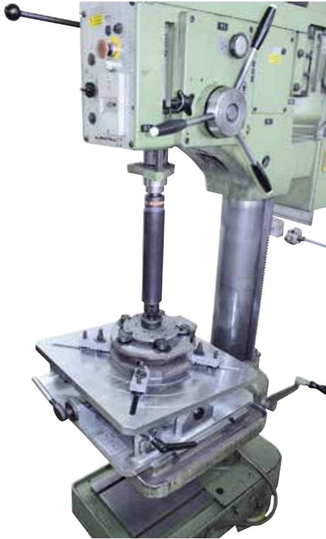
UNT 2 + Adapter, Schleifen eines Schieberkeiles
