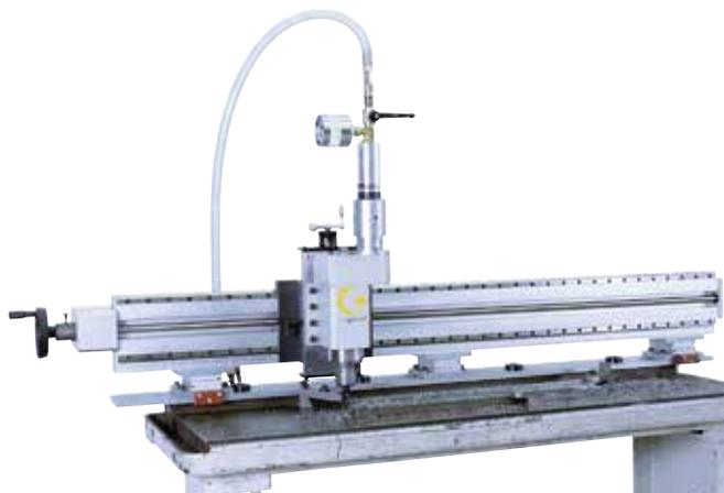
Mobile Fräsmaschine für den Einsatz vor Ort.
