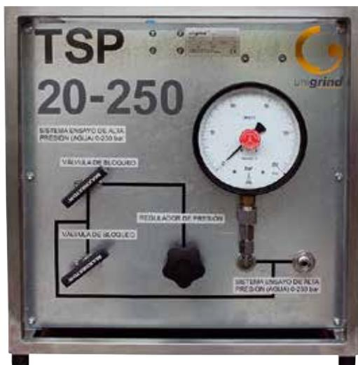
TSP 20-250 transportables Druckprüfsystem ohne Wassertank
