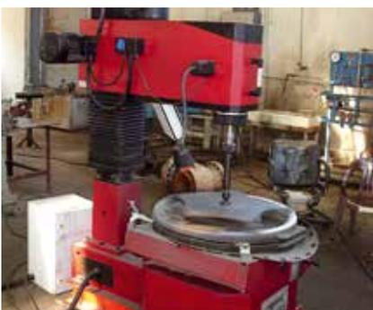
STM 800 E Schleifen eines Schieberkeils
