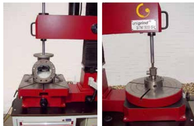
Schleifen eines Schiebers auf dem Neigungstisch    Schleifen eines Sicherheitsventil auf dem Drehtisch
