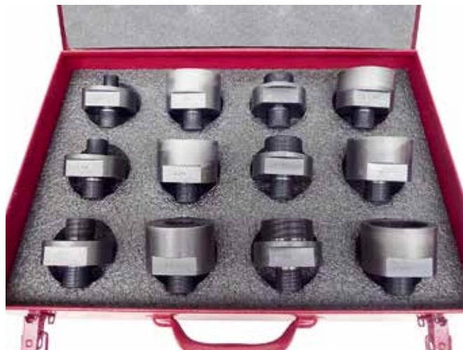
Gewindeadapter für Armaturen mit NPT und BSP Gewindeanschluss
